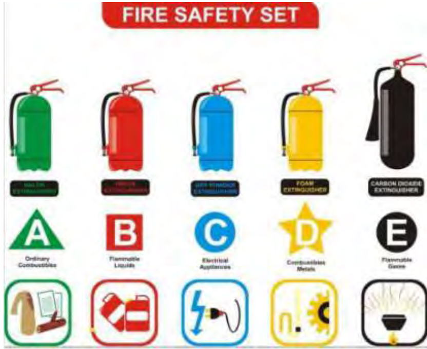
चित्र 4.2.5: अग्निशामक यंत्रों का उपयोग विभिन्न वर्गों के अग्निशामक यंत्रों के लिए किया जाएगा
