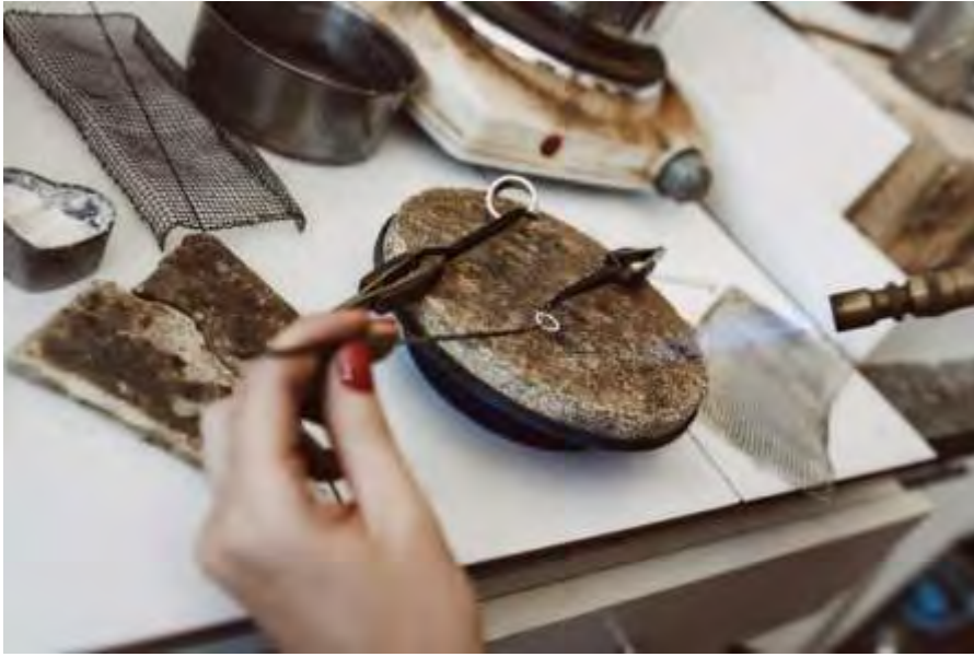
चित्र 1.2.16: वेल्डिंग मशाल से लौ के साथ चांदी की बाली का सोल्डरिंग
